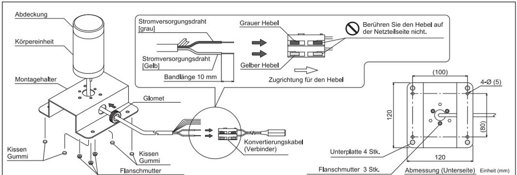
※ Das Ende des Stromkabel muss etwa 9 - 10 mm in der Länge abisoliert werden.
