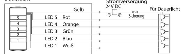
Dauerlicht oder Blinklicht mit akustischem Signal
