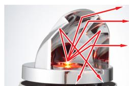
Die LED-Drehspiegelleuchten von PATLITE verfügen über ein einzigartiges (patentiertes) Reflektionssystem, das speziell für diese Modelle entwickelt wurde. Obwohl die Streuung von LED-Modulen geringer ist als die von Glühlampen, erzeugen LED-Drehspiegelleuchten von PATLITE mit diesem Reflektor eine gleichmäßige Streuung.
